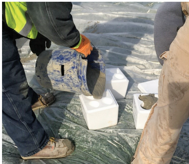
Рисунок 6.1. Отбор проб / тестирование LCC в полевых условиях (Мичиган)
